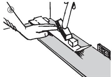
Das letzte Element der ersten Reihe wird, unter Berücksichtigung eines stirnseitigen Dehnungsabstandes von 10–15 mm zur Wand, zugeschnitten und mit dem Montageeisen eingefügt. Mit dem Reststück der ersten Reihe wird in der nächsten wieder begonnen. Dadurch wird der Verschnitt erheblich reduziert. Beachten Sie: stirnseitiger Versatz mindestens 50 cm.
