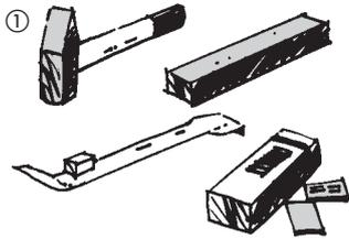
Verlegewerkzeug: Schlagklotz, Abstandskeile, Montageeisen, Hammer (mindestens 800 g), Bleistift; zum Absägen genügt eine einfache Handsäge.
