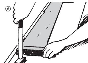
Die weiteren Elemente der ersten Reihe werden stirnseitig mit Hammer und Schlagklotz waagrecht eingeklickt.
