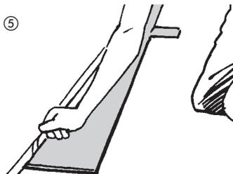
In der rechten Raumecke beginnend wird das erste Element verlegt und mit Keilen fixiert (Dehnungsabstand zur Wand 10–15 mm). Die Elemente werden stets mit der Federseite zur Wand verlegt.
