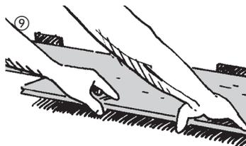
Die weiteren Elemente werden dielenweise verlegt. Dazu werden die Dielen zuerst längsseitig mit leichtem Druck in die Verbindung eingedreht.
