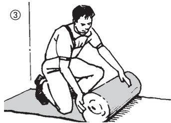
Zur Trittschalldämmung und zum Ausgleich kleiner Unebenheiten wird eine 2 mm dicke Korkdämmunterlage bündig ausgerollt. Alternative Dämmunterlagen finden Sie in unserem Zubehörangebot. Bitumenpappe und Teppichboden eignet sich nicht zur Trittschalldämmung. **Parkettboden mit aufkaschierter Dämmunterlage ist für eine vollflächige Verklebung nicht geeignet.**
