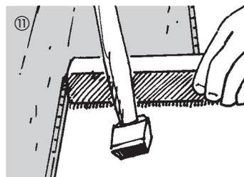
Anschließend wird das Element stirnseitig mit Hammer und Schlagklotz bzw. im Wandbereich mit Montageeisen mit dem rechts angrenzenden Element waagrecht zusammengeklickt.
