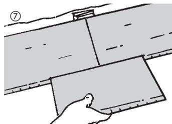
Grundsätzlich ist zur einwandfreien Verlegung der Elemente im Stirnbereich ein elementübergreifender Ansnitt im Längskantenbereich zu verwenden.
