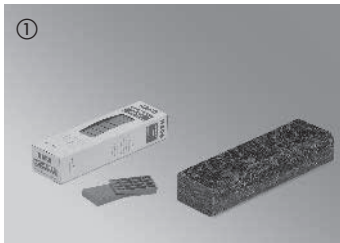
① Værktøj til gulvlægning: Slagklods, afstandskiler, blyant, sav.
