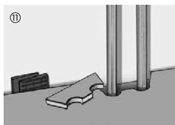
Per i tubi del riscaldamento che spuntano dal pavimento, eseguire delle aperture negli elementi con il trapano o la sega (dimensioni in relazione al tubo di riscaldamento in questione e tenendo conto della distanza di dilatazione necessaria).
