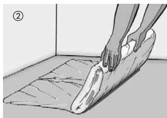
In generale, su tutti i massetti e in caso di posa con riscaldamento a pavimento è necessario utilizzare un foglio di polietilene dello spessore di 0,2 mm e sovrapporlo di 30 cm nell'area di giunzione. Successivamente il foglio va sollevato lungo la parete e tagliato lungo il bordo superiore dopo il montaggio del battiscopa. Il pavimento possiede già una base isolante in sughero incorporata, non è necessario quindi posare una base isolante supplementare.
