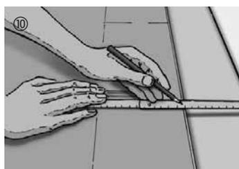
Tagliare e adattare gli elementi dell'ultima fila sul lato lungo tenendo conto di una distanza di dilatazione di 10-15 mm.
