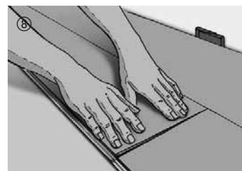
Successivamente l'elemento viene abbassato sul lato corto. Accertarsi che l'elemento si accosti con il lato anteriore a livello con l'elemento posato in precedenza. Premendo brevemente sul giunto orizzontale, l'elemento scatta in posizione.
